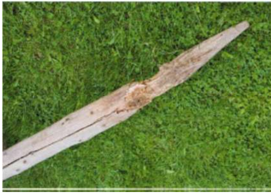
In de laag met de hoogste microbiële activiteit wordt de tuinpaal verteerd, in de lagen erboven en eronder niet.
