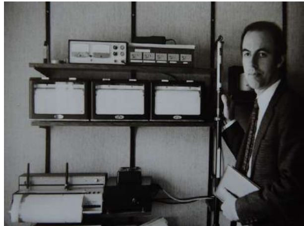
In mijn toenmalige weerkamer de anemograaf, bestaande uit de recorder linksbeneden voor de windrichting (de rechterschrijfpennen) en de windsnelheid (de linkerschrijfpennen), en de drie zwarte meetkasten erboven, met in elke kast twee schrijvende meters, waarmee de golfstructuren van versnellingen in de atmosfeer als een vergroting werden opgetekend. In de 'black box' rechts van de recorder linksbeneden zat het elektronisch brein.
